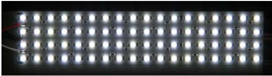
Exemple : Leds 110deg, distance LED/diffuseur ~25 mm, diffuseur 60x10deg
