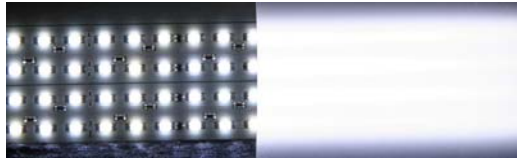
Exemple : Leds 110deg, distance LED/diffuseur ~25 mm, diffuseur 60x10deg
